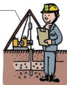
地盤強度計測のための標準貫入試験装置
